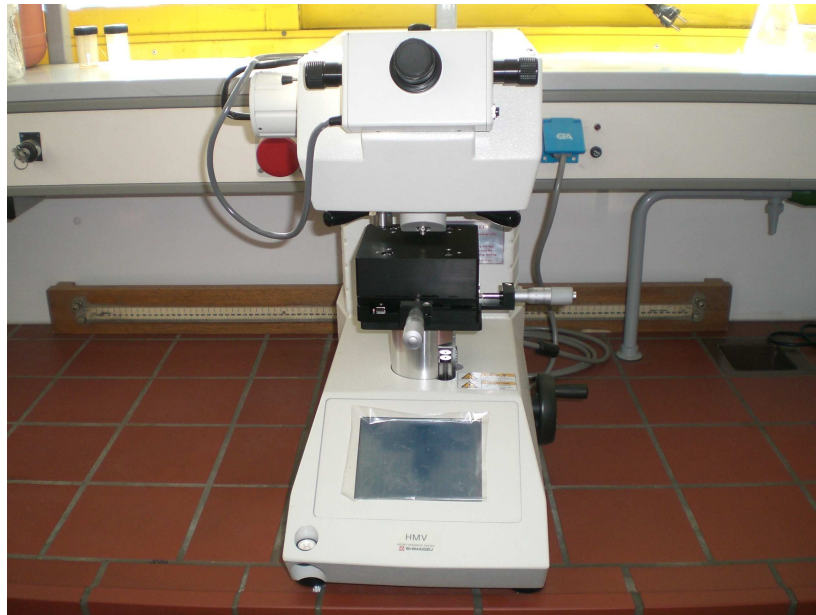
Σχ. 6. Συσκευή μέτρησης σκληρότητας με τη μέθοδο Vickers (SHIMADZU HMV-02)
